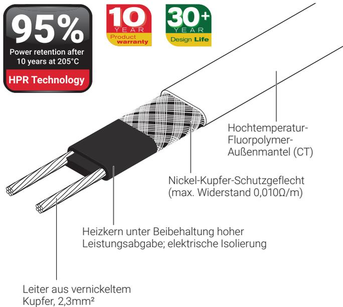
Das selbstregelnde Heizband nVent RAYCHEM HTV ist für den Frostschutz oder zum Halten der Prozesstemperatur bei Rohren und Behältern mit durchgängig sehr hohen Betriebstemperaturen (205°C) ausgelegt.
